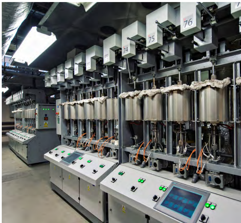
Fot. 6. Sześciostanowiskowe jednopróbkowe maszyny do prób pełzania z układem pomiaru, regulacji i rejestracji temperatury badania oraz systemem pomiaru i rejestracji wydłużenia umożliwiającą prowadzenie badań pełzania w temperaturze do 1000°C przy obciążeniu do 6 kN
