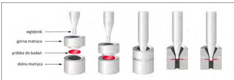
Przebieg badania metodą Small Punch Test
