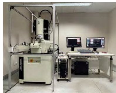
Fot. 8. Wysokorozdzielczy elektrony mikroskop skaningowy (SEM) JSM-7200F firmy JEOL
