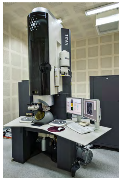
Fot. 7. Ultrawysokorozdzielczy skaningowo-transmisyjny (S/TEM) mikroskop elektrony TITAN 80-300
